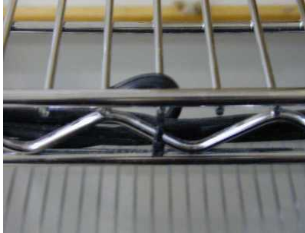
Ilustración 5: Sujete los cables al interior de la unidad de estante con las bandas de sujeción
